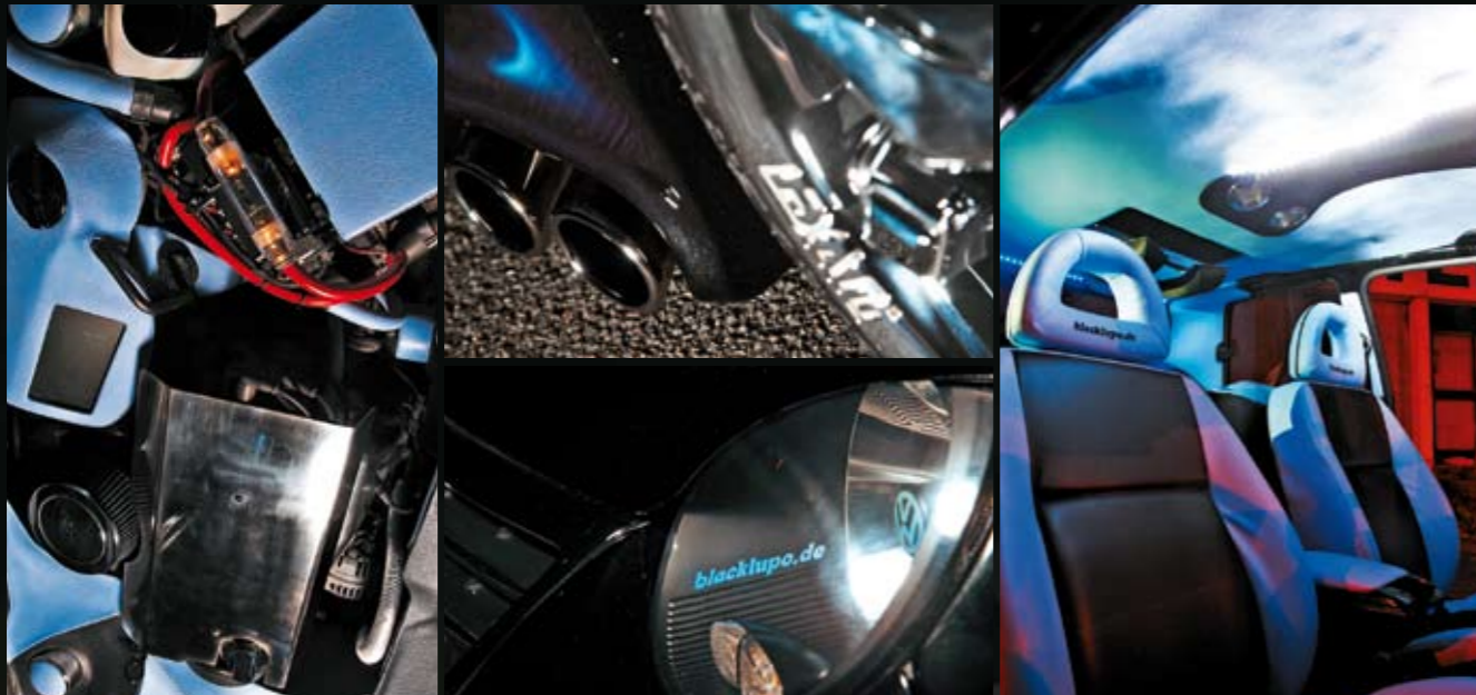
Links: Leder, Edelstahl und Multimedia im Motorraum Mitte oben: Für die Sidepipes wurde eine Schweller Aussparung modelliert Mitte unten: Scheinwerfer mit LED-Blinker und -Standlicht plus VW-Logo Rechts: Alle Lederarbeiten führte Björn gemeinsam mit seiner Mutter aus. Der aus GFK neu konstruierte Dachhimmel wird von LED-Licht durchflutet
