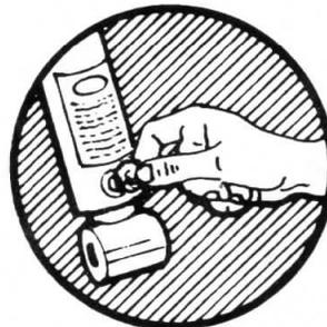
Spax-Stoßdämpfer, der Sportstoßdämpfer mit den 21 Einstellmöglichkeiten (im eingebauten Zustand). Einfach von außen durch jeweils 1/4 Drehung den Spax-Stoßdämpfer auf jede Straßenlage und für jeden Wettbewerb neu einstellen.
