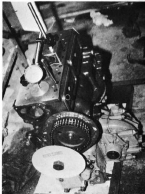
Einstellung des OT am ersten Zylinder. Man erkennt die Gradscheibe und den behelfsmäßigen Zeiger aus Draht.
