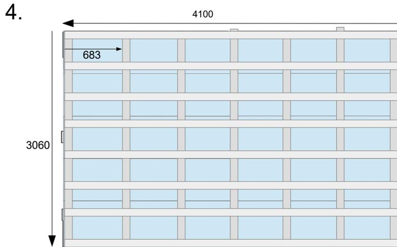
7\* Dachlatte 48\*24 mm im Abstand 683 mm in Längsrichtung und darauf dann 7\* Dachlatte 48\*24 mm im Abstand ca. 437 mm in Querrichtung.
