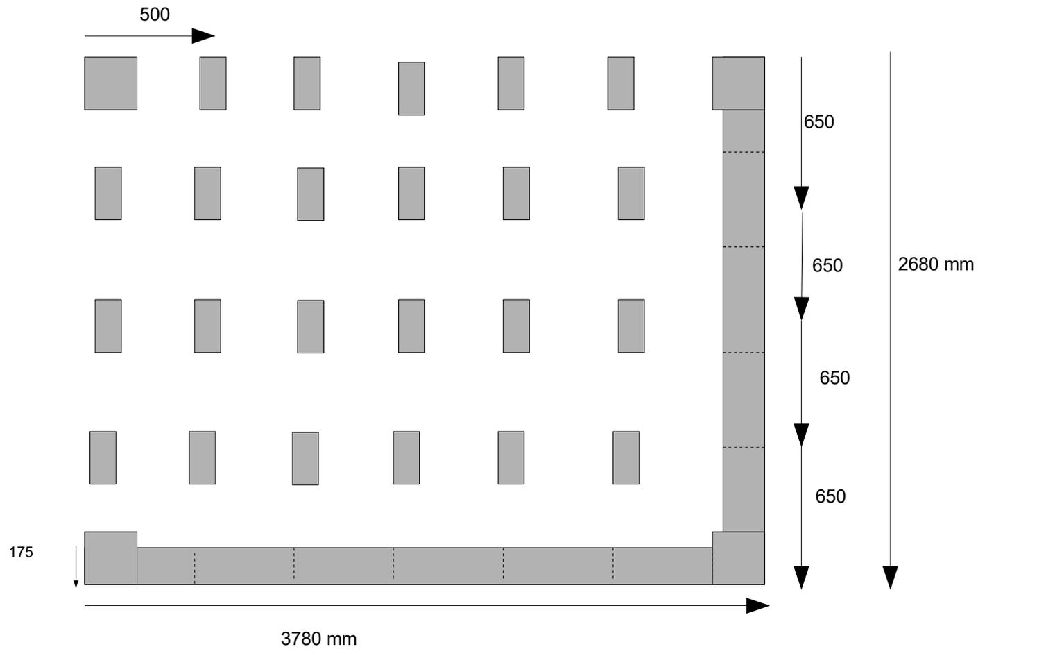
Das zu betonierende Fundament an Stirn und Außenseite soll ca 20 cm breit und 40 cm tief sein. Dabei die rechte Seite ca. 8 cm größer. Dadurch ergibt sich an der Stirnseite ca. 8 cm Auflagefläche um später eventuell die Terrasse aufsetzen zu können.
